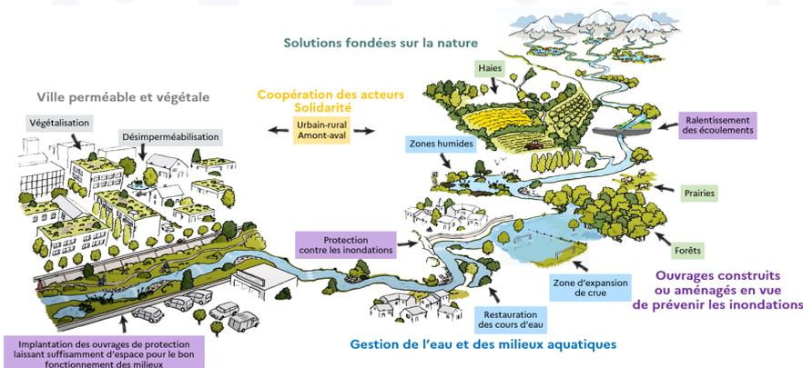
Le PGRI défend d'abord la mise en place à l'amont d'actions de prévention, fondées sur la nature ou structurelles, telles que l'aménagement de la ville perméable et végétale ou la gestion intégrée des eaux pluviales et, en dernier ressort, la mise en place d'ouvrages de protection des enjeux existants. De nombreux programmes et décisions dans le domaine de l'eau et de l'aménagement devront être compatibles avec ce plan.
